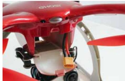
An der Front-Seite befindet sich die Klappe, die den groß-dimensionierten Akku-Schacht verschließt
