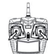
Durch Betätigung der Headless Funktion fliegt der Copter immer in die Richtung in die Sie den rechten Steuerhebel bewegen, unabhängig von der derzeitigen Fluglage und Richtung des Copters. Sie schalten den Headless-Modus ein, indem Sie beide Steuerhebel nach aussen unten ziehen. Der Modus wird durch Blinken der LED signalisiert, bis Sie die Hebel erneut ziehen.
