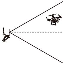
Das Sendesignal zwischen Fluggerät und Fernbedienung ist nur in der hier dargestellten Sendereichweite optimal. Bei einem schwachen Signal müssen Sie die Antennenposition anpassen und den Abstand zwischen Fluggerät und Fernbedienung verringern. Erst dann ist eine optimale Signalstärke gewährleistet.
