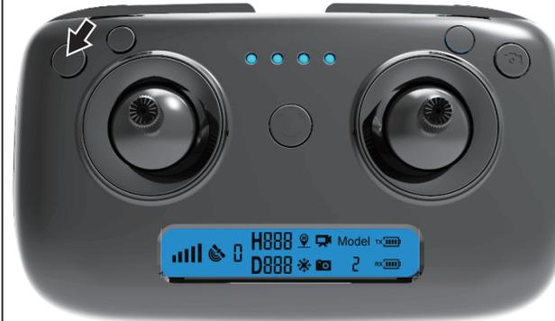
Nachdem das Flugzeug die Frequenz erfolgreich überquert hat, wird das Flugzeug auf den flachen Boden gestellt. Halten Sie die Geschwindigkeitstaste ca. 5 Sekunden lang gedrückt. Die Fernbedienung senkt sich und die Flugzeuglichter blinken schnell und die Taste wird losgelassen. An dieser Stelle können Sie nach dem GPS-Signal suchen. Nachdem das Licht eingeschaltet ist, können Sie das Flugzeug zum Entriegeln und Starten steuern. Wenn Sie kein GPS-Signal benötigen, können Sie direkt starten.
