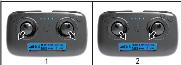
Zu diesem Zeitpunkt werden der Gashebel und der Richtungshebel gleichzeitig in die untere linke Ecke und die untere rechte Ecke (1) oder gleichzeitig in die untere rechte Ecke und die untere linke Ecke (2) gedrückt kann die Entriegelung abgeschlossen und der Motor nach dem Start gestartet werden.
