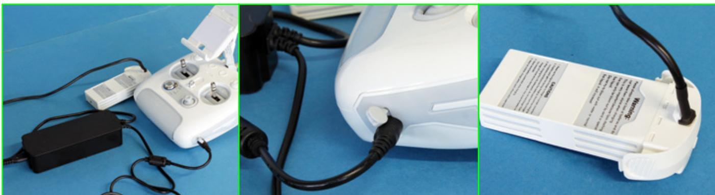
Das beiliegende Ladegerät befüllt den Flug- sowie den Sender-Akku parallel. Der Hochvolt-LiPo wird über einen Balancer-Anschluss geladen
