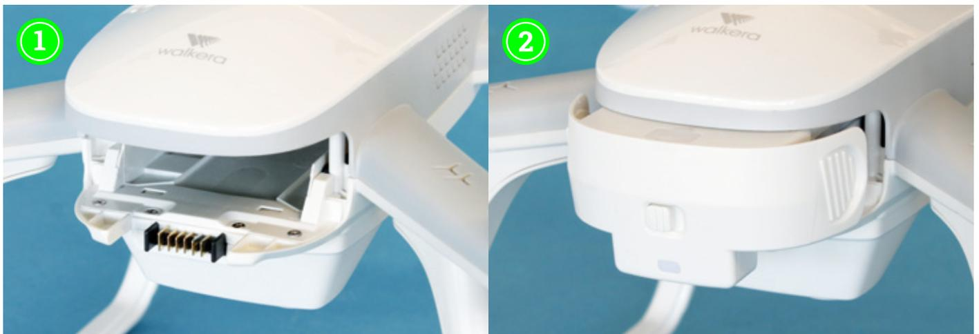
Am Heck des Kopters ist der großdimensionierte Schacht für den Akku. (1) Die elektrische Verbindung wird hergestellt, sobald man den Energiespender einschreibt. (2)
