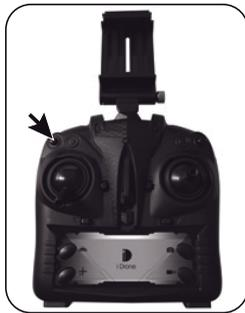
Wenn der Copter ausser Kontrolle gerät oder im Notfall, betätigen Sie den Geschwindigkeits Taster und halten ihn gedrückt. Die Motoren stoppen dadurch sofort. Führen Sie dieses Manöver nur aus, wenn sich keine Menschen oder Tiere in direkter Nähe des Copter aufhalten und durch das Herabfallen des Copters verletzt werden können.
