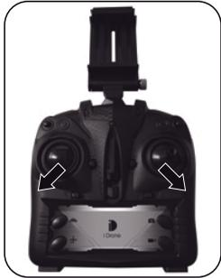
Wenn der Copter & der Sender verbunden sind, schalten Sie den Copter frei zum Fliegen indem Sie beide Steuerungs Sticks nach unten aussen ziehen. Die Motoren fangen an zu laufen und Sie können vorsichtig abheben. Betätigen Sie den linken Stick zum Steuern der Flughöhe. Mit dem rechten Stick kontrollieren Sie die Flugrichtung.
