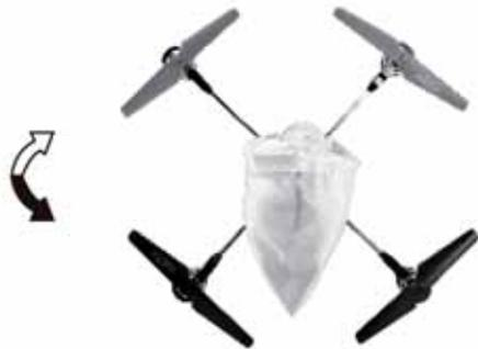
Drücken sie den linken Joystick nach links oder rechts und die Drohne dreht sich um die eigene Achse nach links oder rechts.
