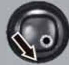
Falls sich ihr Drohne nicht wie gewünscht steuern lässt, müssen sie die Fernbedienung kalibrieren. Drücken sie die Joysticks wie in der Grafik gezeigt nach rechts unten bis die LED anfängt zu blinken. Danach lassen sie die Joysticks los. wenn die LED nun dauerhaft leuchtet ist die Kalibrierung abgeschlossen.
